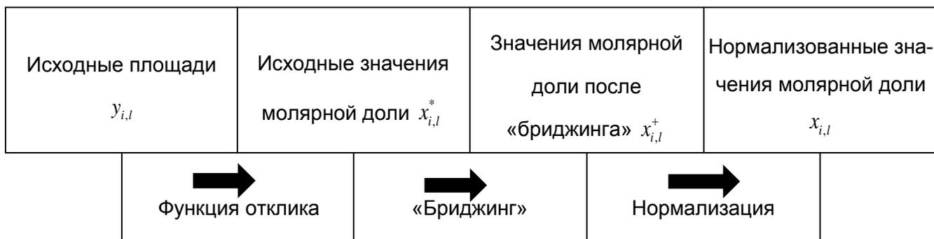
Рисунок А.2 - Блок-схема процесса преобразования данных
