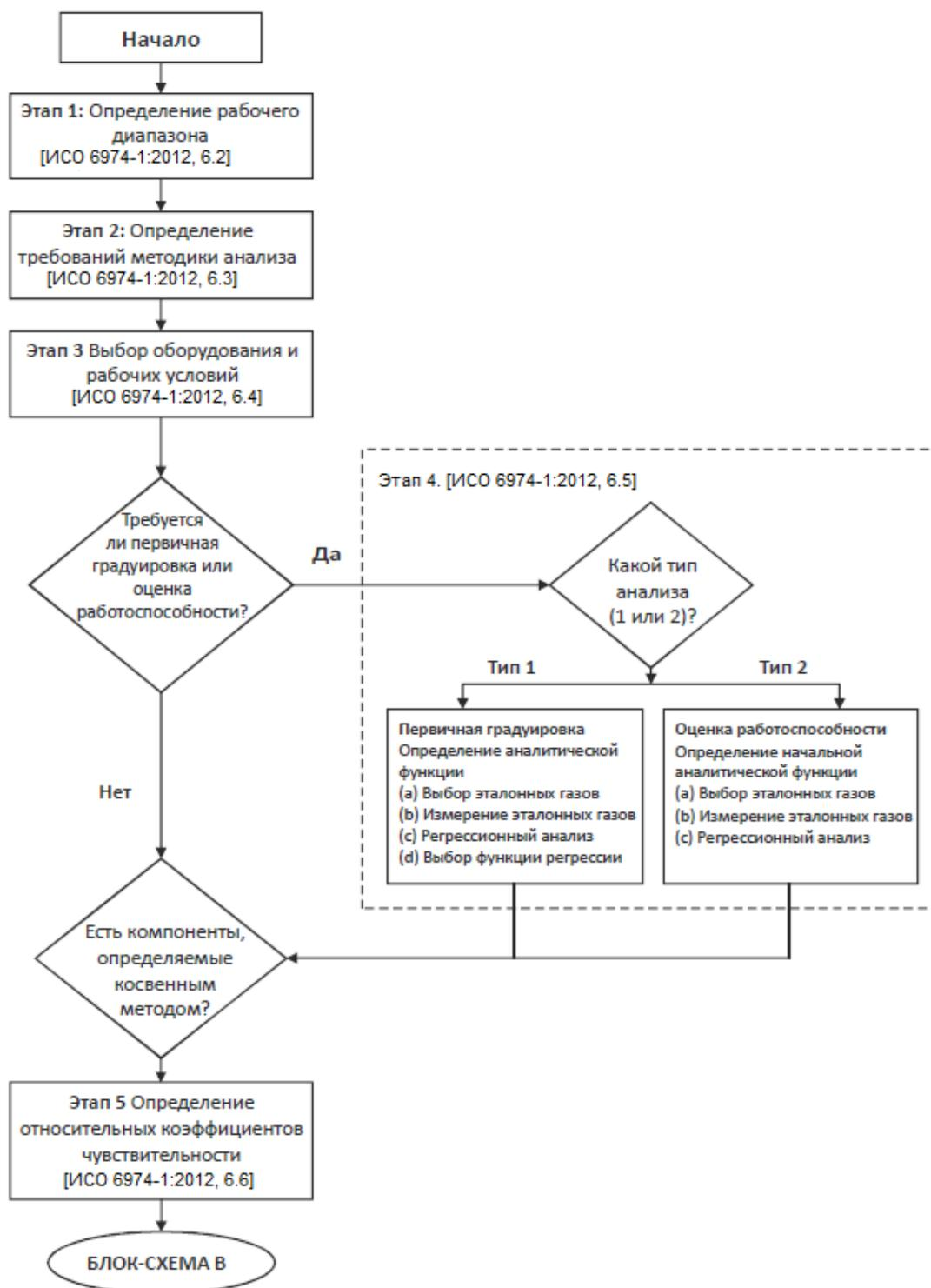
Рисунок 1 – Процедуры определения молярной доли и неопределенности —
