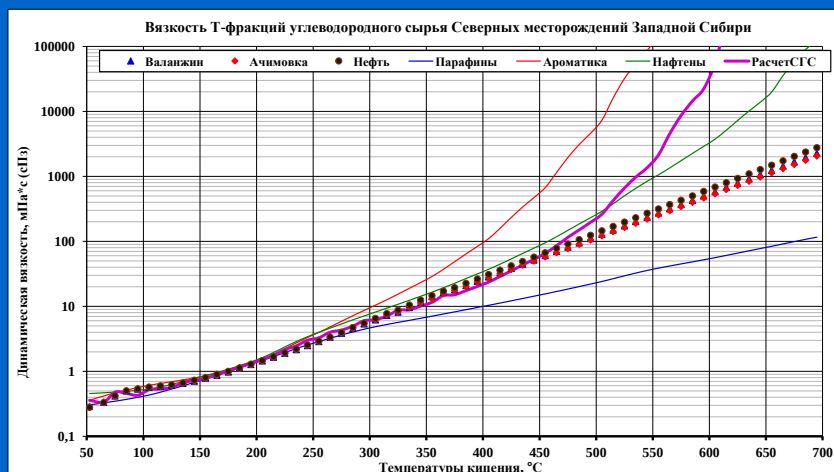
Рис – Сравнение расчетов ФХС хроматографических фракций СГС-методом со среднестатистическими данными экспериментальных определений для фракций разгонки
