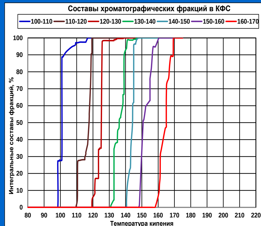
Рис. - Узкие фракции хроматографического определения и фракции, выделенные методом фракционной разгонки
