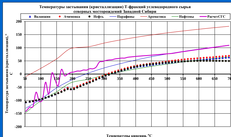
Рис – Сравнение расчетов ФХС хроматографических фракций СГС-методом со среднестатистическими данными экспериментальных определений для фракций разгонки
