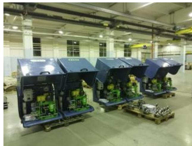
Группой компаний «ЭлМетро» с 2018 по 2021 год изготовлено около **750 шт.** расходомеров **ЭЛМЕТРО-Фломак** ДУ 2, 3 и 5 мм. Около 90% из общего количества используются при дозировании различных реагентов, ингибиторов и присадок. Основным из них является – метанол, водометанольный раствор.
