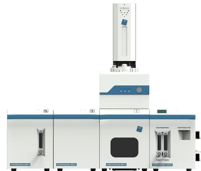
Анализатор СПЕКТРОСКАН МЕТА с вертикальным блоком печи и автоматическим дозатором жидких проб
