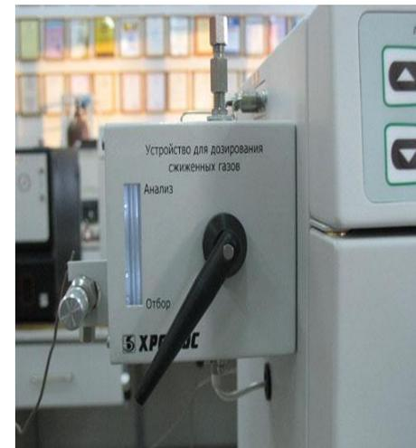
Устройство для дозирования СУГ, обеспечивающее ввод жидкой пробы без разгазирования
