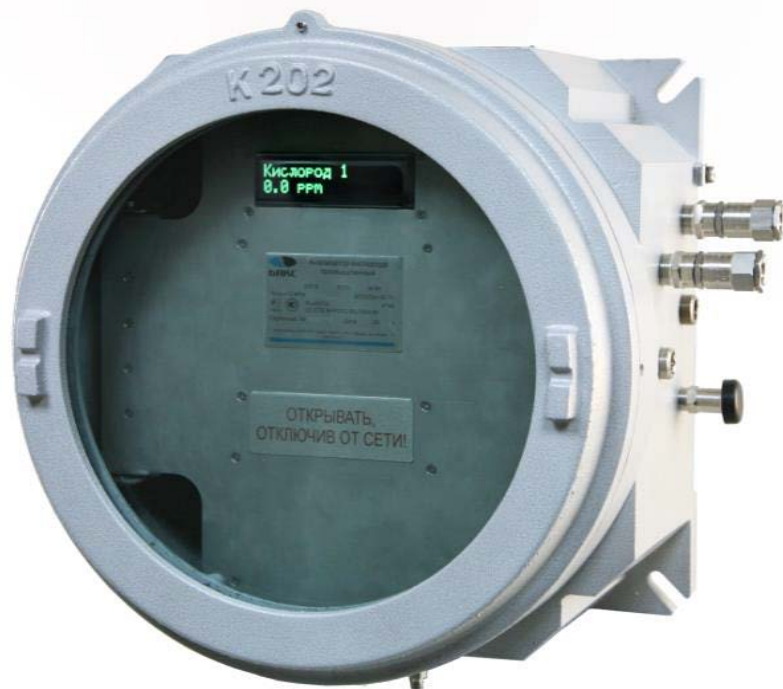
Потоковый анализатор кислорода ООО «НПФ БАКС» АНОкс Диапазон измерений: 0 до 100 % об. Точность: (1,5+0,05 \cdot x) ppm.
