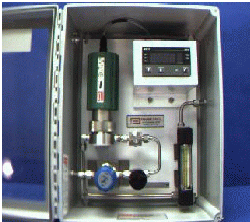
Потоковый анализатор кислорода GE Panametrics Inc. O2X1 Диапазон измерений: 0 до 25 % об. Точность: 6 % в диапазоне 0-100 ppm.
