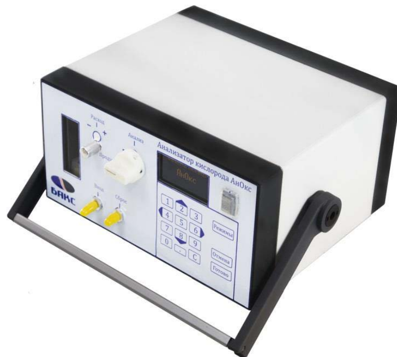
Портативный анализатор кислорода ООО «НПФ БАКС» АНОкс Диапазон измерений: 0 до 100 % мол. Точность: (1,5+0,05 \cdot x) ppm.
